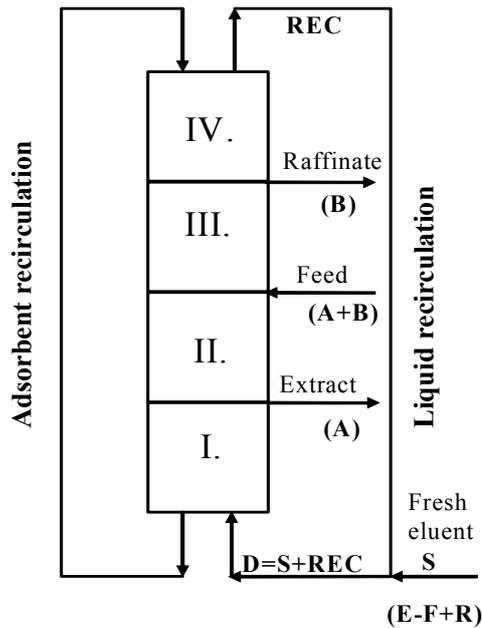
Fig. 1. True Moving Bed (TMB)
